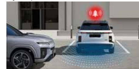
Asystent wykrywania ruchu poprzecznego z tyłu pojazdu
